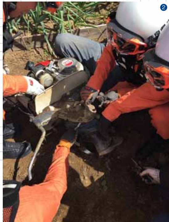
左右にあるロータリー部分のうち巻き込まれていない右側部分を工具を使用して取り外しにかかる。
