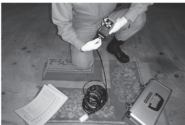
写真2 ガス導入管と本体を接続します ガス導入管と本体を接続します。
