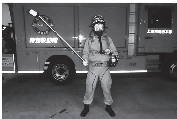
写真5 ガスの比重は様々なので、上下左右を広く測定します
