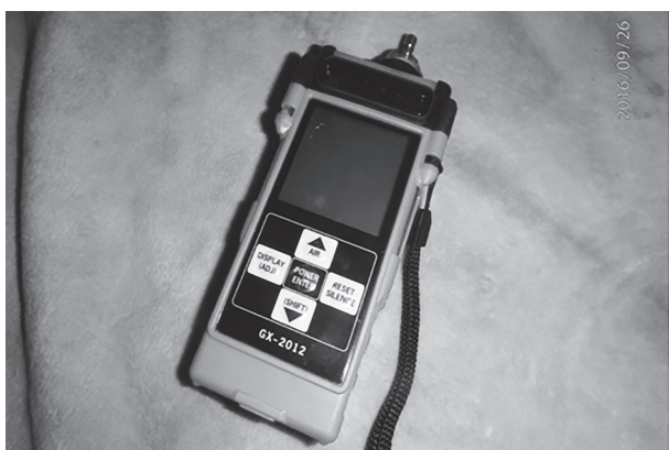
写真4 導入管を接続しなくても測定は可能です。 導入管を接続しなくても測定は可能です。
