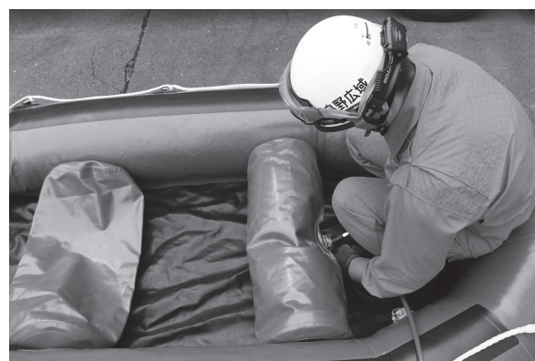
写真5 各気室には平等に圧力かけることが大切
