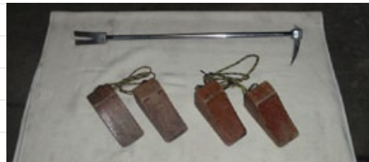
乗用車に使用した救助資機材 上／ホリガンツール、車輪止め 下／スプレッダー
