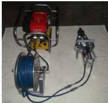
乗用車に使用した救助資機材 上／ホリガンツール、車輪止め 下／スプレッダー
