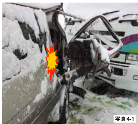
ホリガンツールで間隙を作成。ドアが変形していたので、スプレッターを使わずにカッターが挿入できた。
