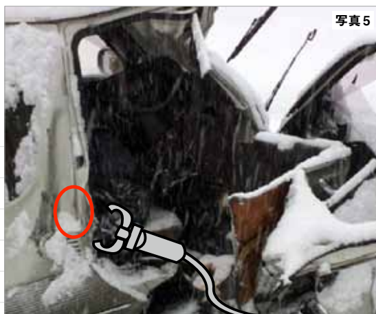
カッターでドアロックを切断しドアを開放。
