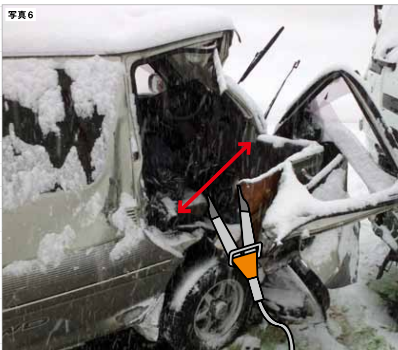
スプレッダーを使用し、シート下部からフロントパネル下方にかけて開放しスペースを作成。
