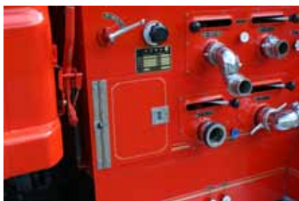
助手席側のポンプのメンテナンス・点検口。
