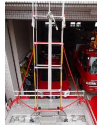
上/車両を建物に対して平行に部署して架梯することを想定し、左右に2か所ずつ底部を設定する溝を設定。底部を固定するためのD環も四隅に設置している。下/車両の部署位置に応じて、建物側と車道側の溝を使い分け、架梯角度を調整することもできる。
