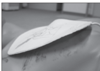
図8 浮き上がりはNGです
